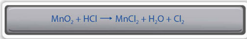
Fig. 4.57 Reacción de óxido de manganeso con ácido clorhídrico para producir cloruro de manganeso, cloro diatómico y agua.
