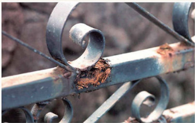
Fig. 4.64 Los factores que participan en el proceso de corrosión son la estructura de la pieza que se oxida, el ambiente y el agua.
