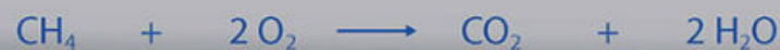
Fig. 4.44 En las reacciones de combustión, los productos siempre son dióxido de carbono y agua. En la reacción inferior, se muestra de manera gráfica la combustión del metano.
