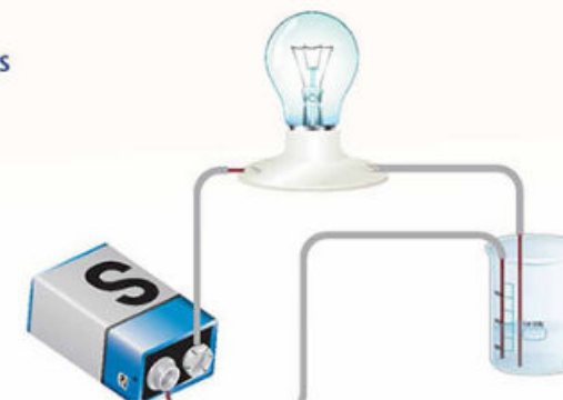
Fig. 1.36 Representación del conductímetro diseñado.
