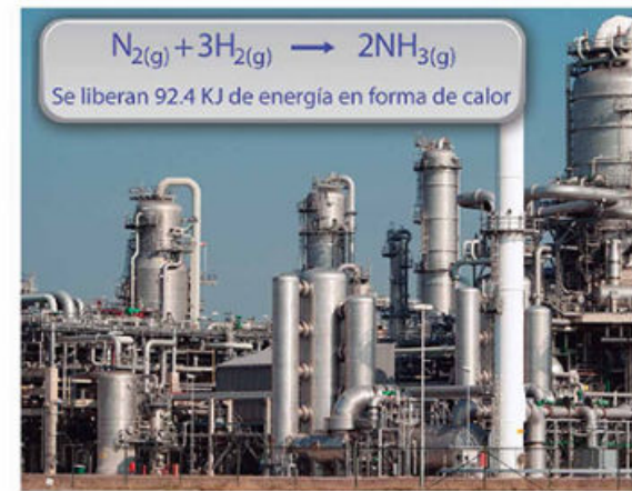
Fig. 3.25 Planta de producción de amoníaco. Durante la síntesis de este compuesto se libera energía calorífica (medida en kilojoules, KJ).
