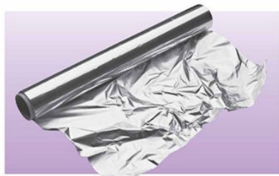
Fig. 2.35 La maleabilidad es la propiedad de los metales para formar delgadas láminas.
