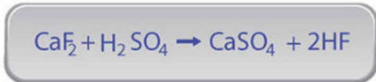
Fig. 3.22 Reacción de formación del sulfato de calcio a partir de fluoruro de calcio y ácido sulfúrico, correctamente balanceada.
