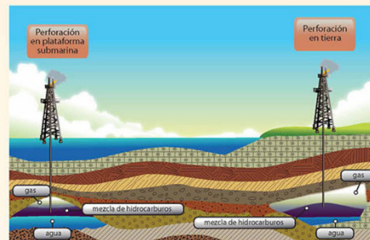
Fig. 4.62 Estructura de un yacimiento de petróleo.
